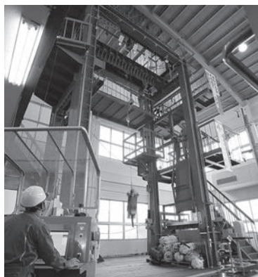
屋内試験鉄塔
